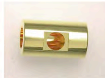
Thin wall (1 \mu m) hohlraum
